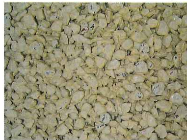
K-グラウンド (C) 透水性&amp;保水性舗装表面
